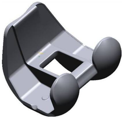
Fig. 12 Geometrie implant reconstituită în aplicația Rapidform XOR3
