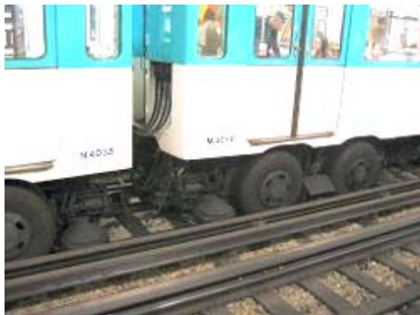
Fig. 1 Trenuri din Metroul parizian cu roți de cauciuc
