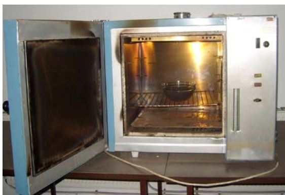
Fig. 5 Etuvă pentru uscarea amestecului de deșeuri
