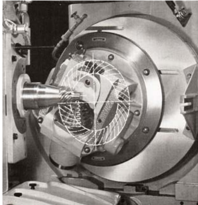
Fig. 1 Angrenarea pinionului cu roata plană virtuală, generată de freza melc conică, pe mașina universală de frezat roți dințate conice Klingelberg-Palloid, tip AFK 201 AVAU [1]
