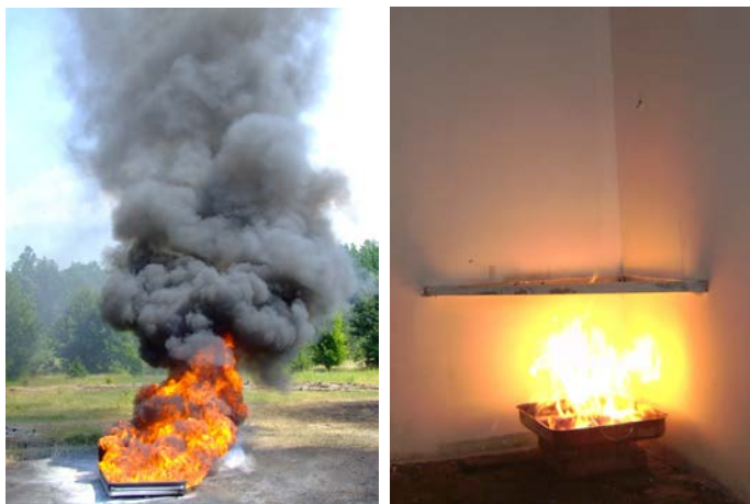
Fig. 1 Comparație vizuală între arderea benzinei (stânga) și arderea etanolului (dreapta), din punct de vedere al cantității de fum eliberate
