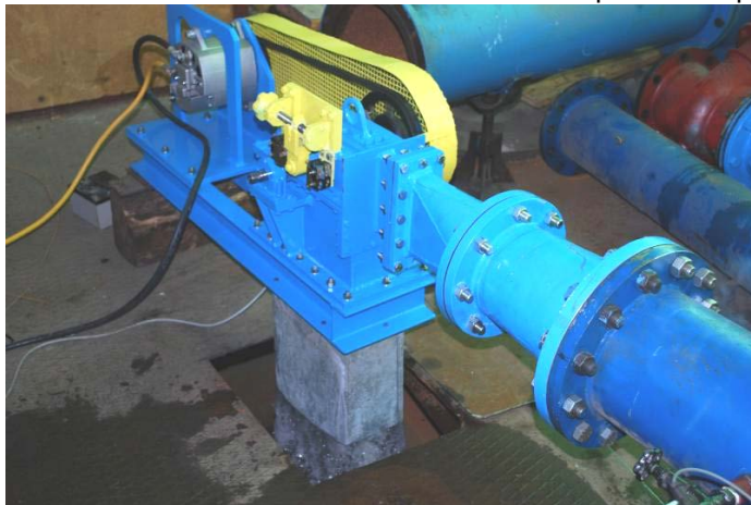
Fig. 2.1 Micro-hidroagregatul cu turbină de tip cross-flow de 10 kW, pe standul hidraulic, în timpul efectuării celui de-al doilea set de măsurători
