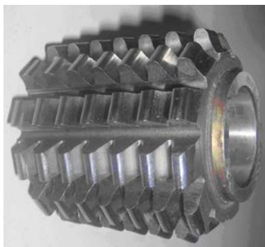
Fig. 3 Freză melc pentru danturarea roții dințate, conjugată pinionului cu bolțuri, studiu de caz (Fotografie realizată la S.C. Sculăria Cugir srl)
