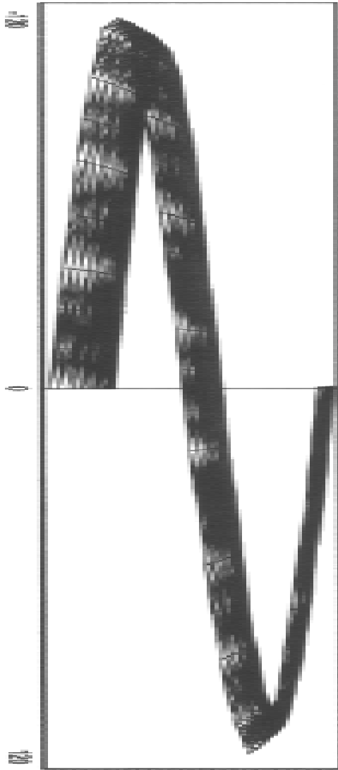
Fig. 9 Reprezentarea sub forma unei rețele de puncte a suprafeței melcului toroidal, văzută din poziția laterală
