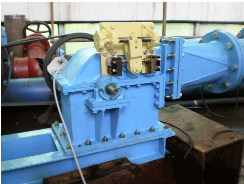
Fig. 2.2 Micro-hidroagregatul cu turbină de tip cross-flow de 10 kW, pe standul hidraulic, în timpul măsurătorilor
