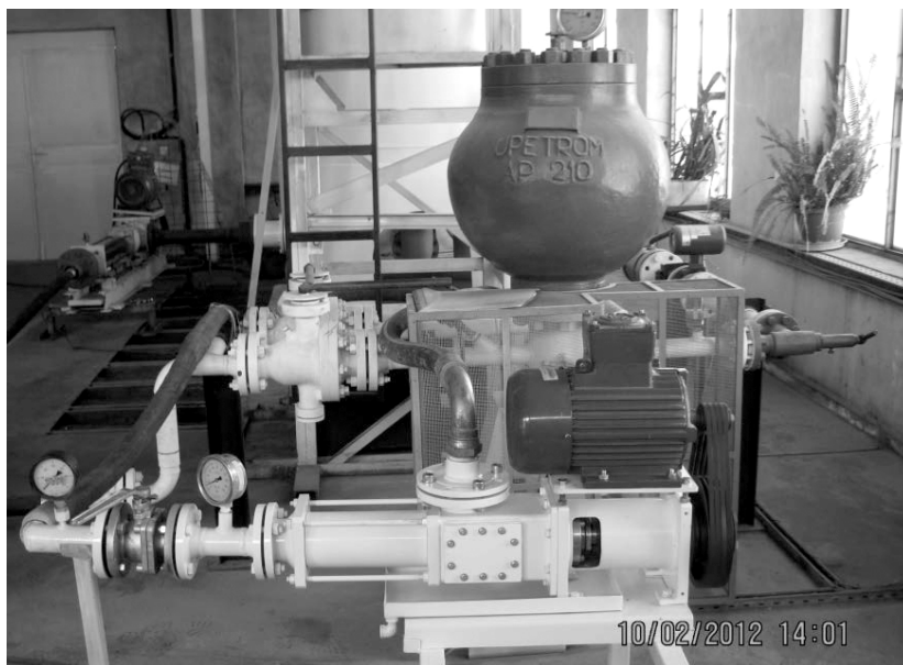
Fig. 7 Standul CONFIND de probat pompe cu cavități progresive, cu 3 posturi: unul pentru pompe mici (în prim plan), altul pentru pompe medii și mari (pe latura din stânga) și altul pentru pompe verticale [5.3]
