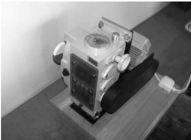
Fig. 7 Machetă funcțională a unui variator de turație având lanț cu role pretensionat și reductor încorporat ce face parte din proiectul de diplomă al coautorului prezentei lucrări [1]
