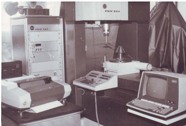
Fig. 10 Verificarea frezei melc conice pe mașina de măsurat în coordonate Leitz tip PMM 864 (fotografie realizată la S.C.Sculăria srl Cugir) [1]
