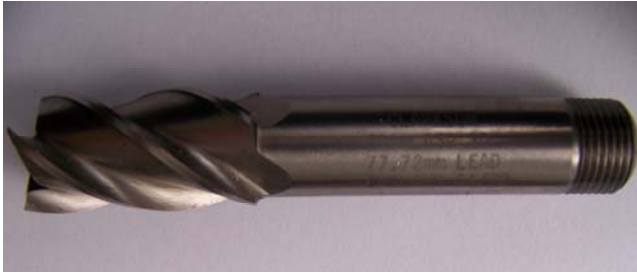
Fig. 1 Freză cilindrofrontală având suprafața elicoidală de degajare rectificată conform cerințelor actuale
