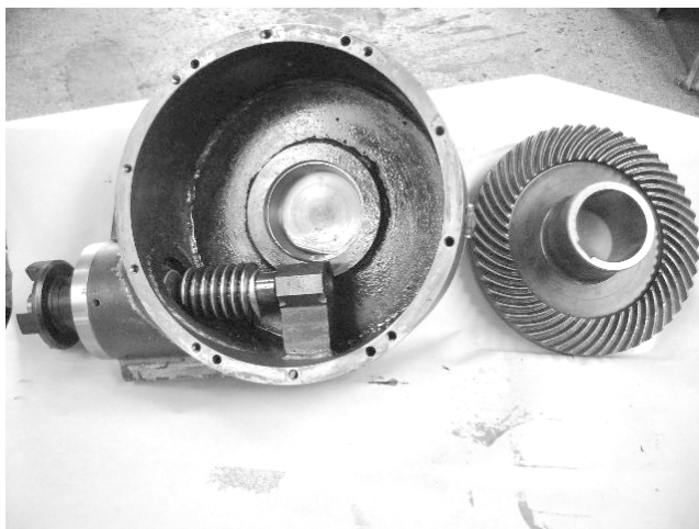
Fig. 2 Angrenajul melc-roată plană, studiu de caz, care este încorporat în reductor (fotografie realizată la S.C. Sculăria s.r.l. Cugir)
