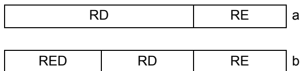
Fig. 3 Clasificarea receptoarelor trifazate: clasică (a) și propusă (b)
