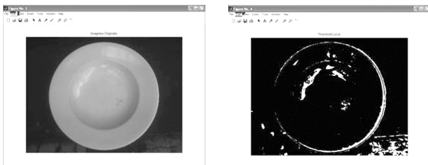
Fig. 3 Rezultatul simulării prin aplicarea metodei threshold
