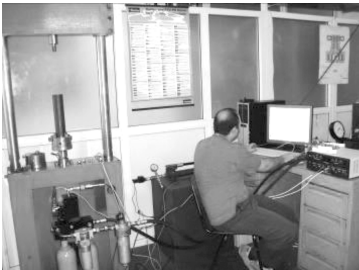
Fig. 2 Standul de testare dinamică a motoarelor hidraulice liniare
