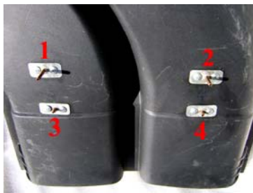
Fig. 6 Standul experimental a – vedere generală, b – detaliu privind prizele de presiune
