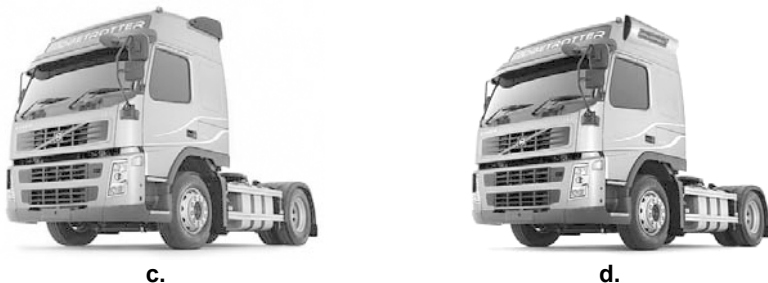
Fig. 5 Detalii privind fixarea captatorului a – vedere generală, b – detaliu din interiorul captatorului, c – capul tractor Volvo fără captator, d - capul tractor Volvo cu captatorul montat
