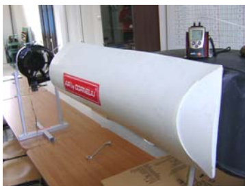
Fig. 6 Standul experimental a – vedere generală, b – detaliu privind prizele de presiune
