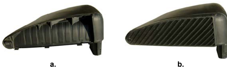
Fig. 2 Camera traseului de aducțiune a – fără grila perforată, b – cu grila perforată montată
