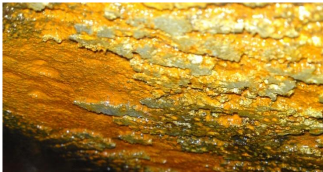
Fig. 7 Dezvoltarea cavitațională bidirecțională
