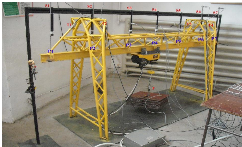
Fig. 1 Macheta macaralei construită la scara 1:10
