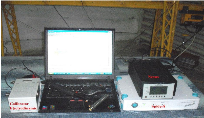
Fig. 2 Aparatură și montaj pentru studiul sub sarcină al grinzii principale – profil I
