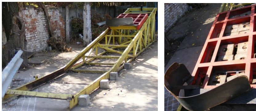
Fig. 1 Structura rampei de lansare și căruciorul de impact
