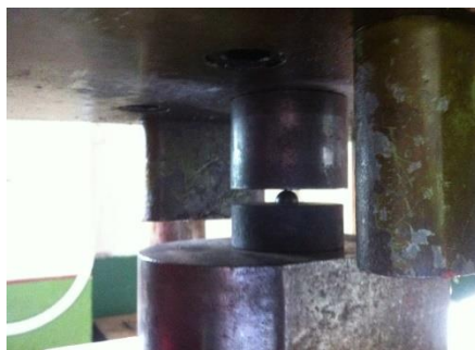
Fig. 2 Încercarea de compresiune a unei bile de D_w = 12,7 mm
