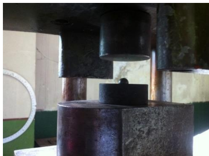
Fig. 1 Bila de rulment poziționată în mașina universală de încercat
