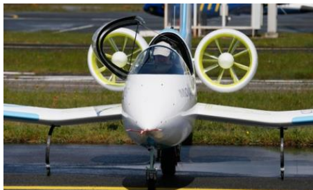
Fig. 3 Avionul monobloc cu două motoare electrice Airbus E – Fan
