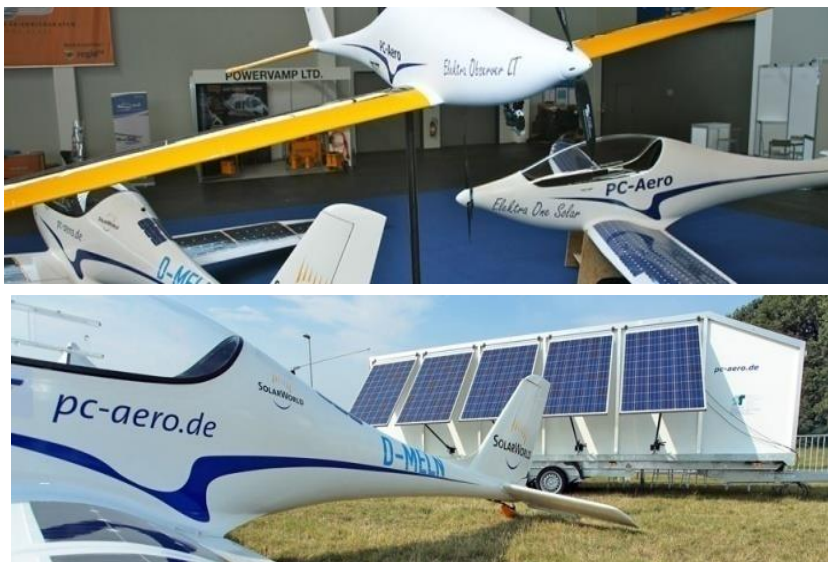
Fig. 5 Avion cu motor electric Electra One Solar și hangar cu panouri solare P.C. Aero G.m.b.H
