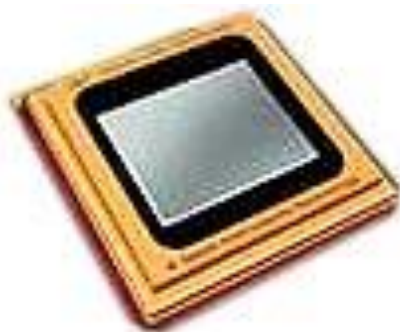
Fig. 2 Dispozitiv optic DMD
