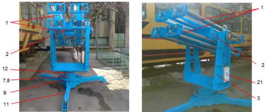
1 - Grindă lansare, 2 - Etajera, 3 - Leagănul azimut/înălțare, 7 - Axul de azimut, 8 - Picior, 9 - Scala azimut, 11 - Labă picior, 12 - Traductor azimut, 21 - Bloc distribuție
