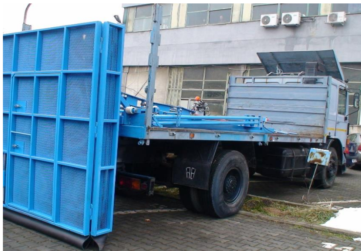
Fig. 1 Echipament mobil de blocare căi de acces cu pachetul de panouri rabătut hidraulic
