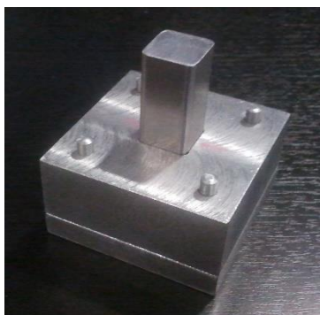
Fig. 4 Ansamblul placă de bază - matriță - poanson
