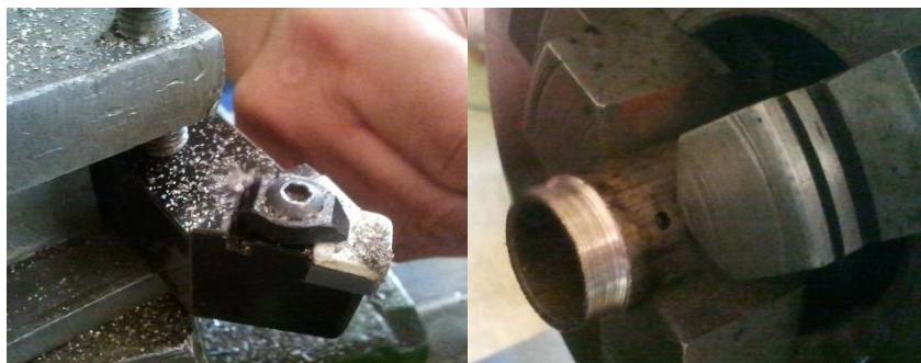
Fig. 9 Suprafața prelucrată și așchiile rezultate
