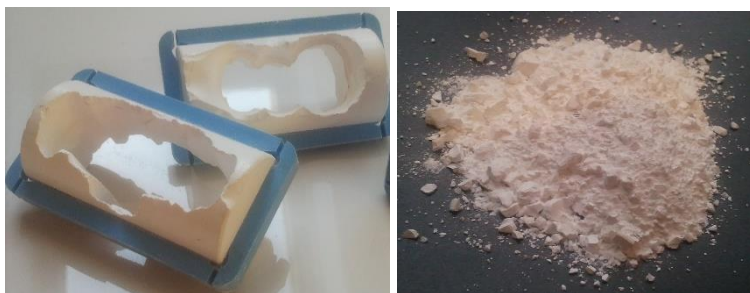
Fig. 5 Deșeurile de oxid de zirconiu rezultate în urma frezării implanturilor dentare și pulbera de oxid de zirconiu obținută în urma zdrobirii deșeurilor
