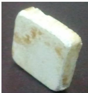
Fig. 8 Plăcuța aşchiitoare obținută în urma sinterizării
