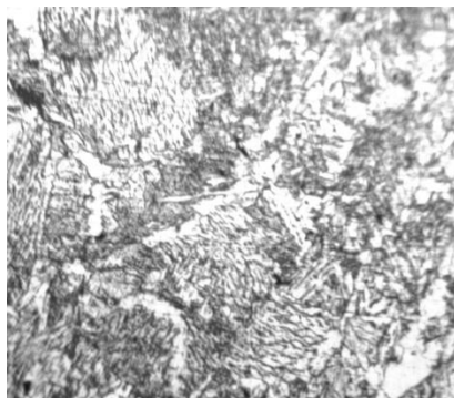
Fig. 13 Proba E1T, ZIT, atac Nital 2%, 100X
