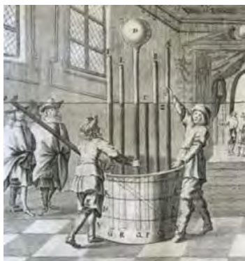
Fig. 16 Experiențele lui Torricelli și Viviani în care se demonstrează paradoxul hidrostatic, anul 1644 [42]
