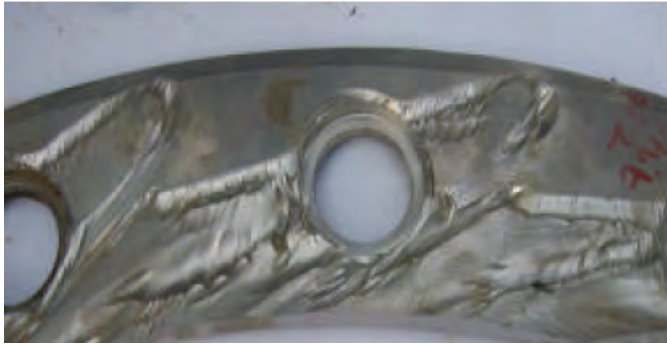
Fig. 5 Eroziune dată de curgerea secundară cu vortex pe inelul superior al aparatului director, [12]
