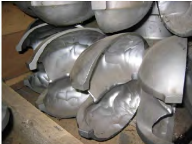
Fig. 6 Eroziune accelerată a cupelor rotorului de turbină Pelton, [11]
