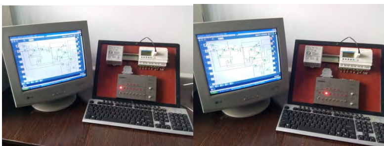
Fig. 9 Standul de laborator cu AP Zelio Schneider Electric și modul de simulare Schenck în diverse momente de testare a aplicației
