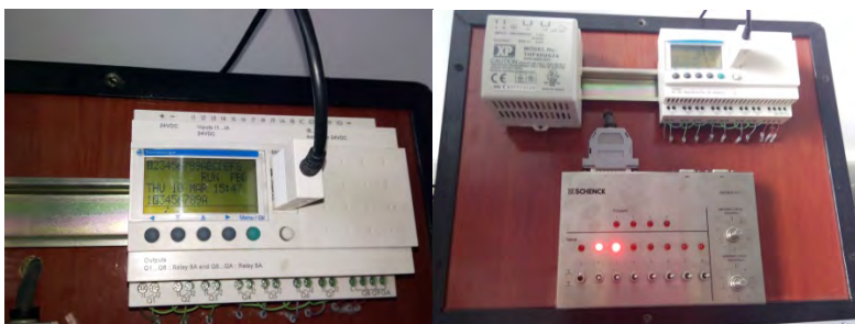
Fig. 8 Standul de laborator cu AP Zelio Schneider Electric și modul de simulare Schenck cu intrări analogice și digitale în timpul testării aplicației
