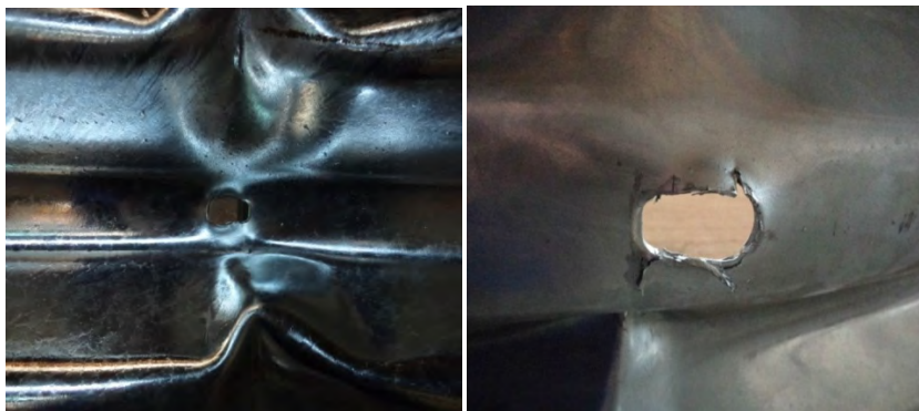
Fig. 6 Detaliu gaură de prindere a lisei în urma testului
