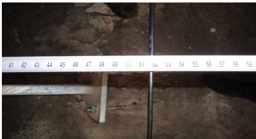
Fig. 10 Deflexiunea dinamică a parapetului. Detaliu
