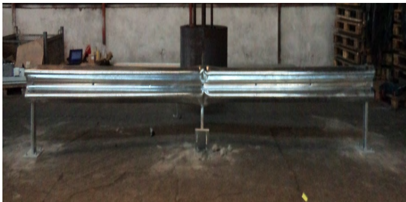
Fig. 3 Parapet deformat la impactul cu pendul
