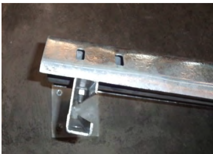
Fig. 8 Stâlp capăt stânga deformat
