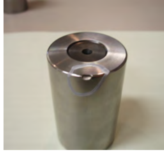
a) b) Fig. 1 Defecte ce apar în timpul proceselor tehnologice, a) și defect de material, b)
