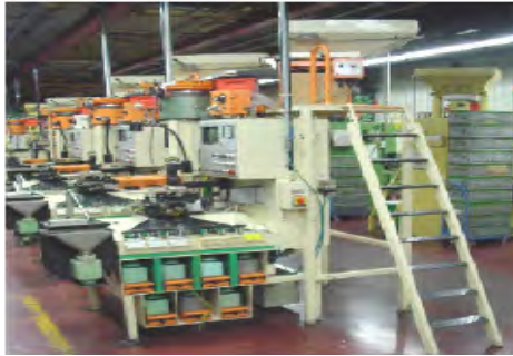
Fig.4 Mașina de clasificat role de rulmenți
