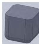
Fig. 3 Creare geometrie „Cub 3” (racordare 8 muchii, lateral și bază jos)
