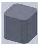
Fig. 2 Creare geometrie „Cub 2” (racordare 4 muchii, R = 10 mm)
