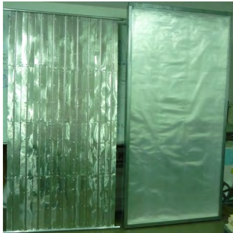
Fig. 2 Captatorul solar plan realizat din materiale cu masă redusă
