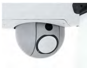
Fig. 10 UAV Schiebel S-100 Camcopter cu stabilizat bazat pe IAI/Elta POP-300
