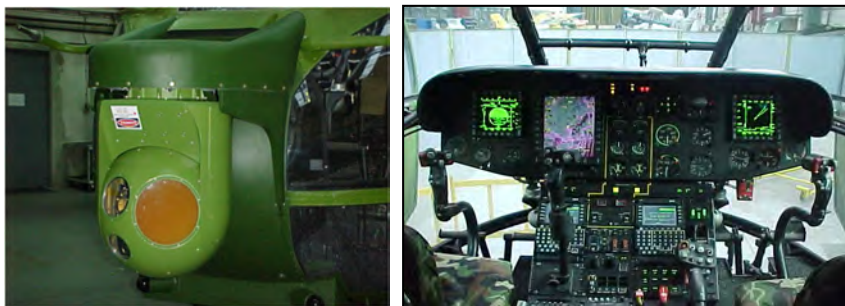
Fig. 3 Sistemul EOP - Observation System Day – CCD, Night – FLIR, Laser Range Finder și GLASS COCKPIT cu VCR System și Real Time (frame by frame) transmission to/from ground
