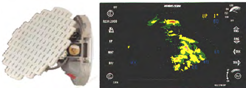
Fig. 6 Planșa de bord IAR 330L NATO și sistemul de antenă și display RADAR METEO
