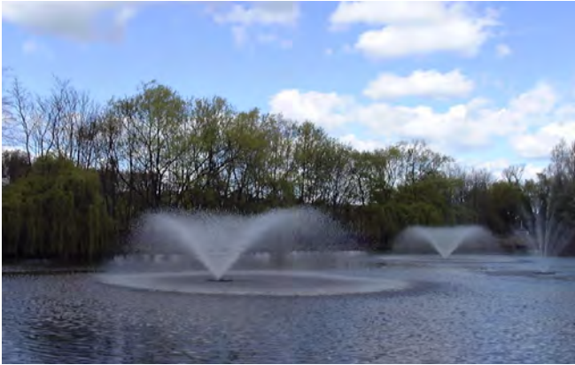
Fig. 4 Ansamblu de două echipamente Oxy-Jet în funcțiune pe un bazin de mari dimensiuni
