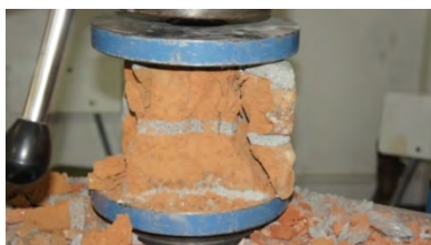
Fig.5 Faze de rupere a cărămizilor la încercări
