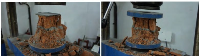
Fig.7 Faze de rupere a cărămizilor la încercări
