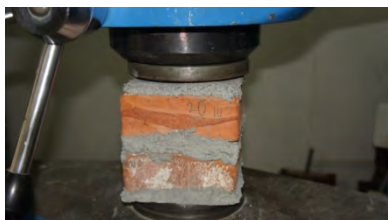
Fig.4 Poziționare probei în presă
