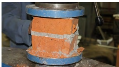
Fig.5 Faze de rupere a cărămizilor la încercări
