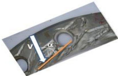
Fig. 1 Mecanismul eroziunii abrazive. Suprafața a inelului superior al aparatului director al unei turbine hidraulice, [4]
