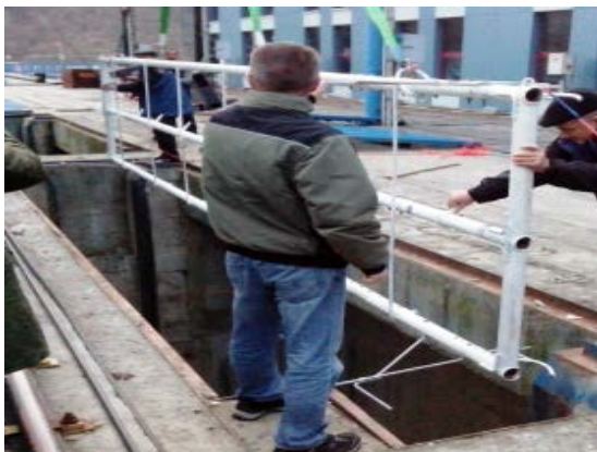
Fig. 3 Lansare cadru semi-mobil cu moriști hidrometrice în nișele batardourilor amonte de la CHE Robești
