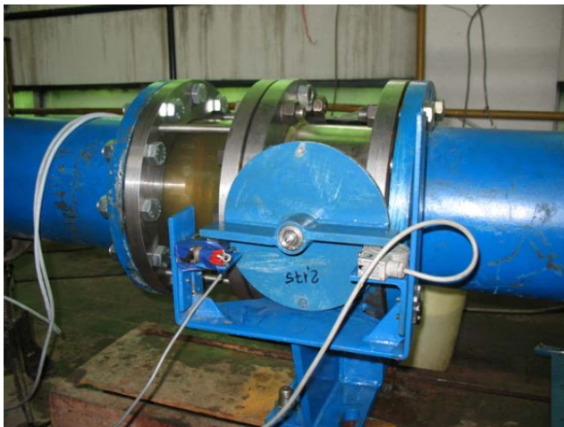
Fig. 3 Amplasare model vana fluture cu disc biplan în standul de teste
