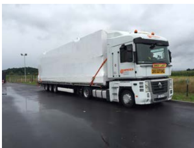
Fig. 1 Penthouse încărcat pe platformă
