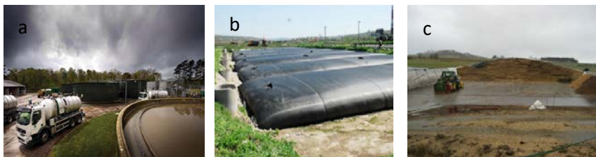
Fig. 3 Itinerarul nămolului: a) manipularea nămolului [13]; b) stocare temporară a nămolului în saci [14]; c) depozitarea nămolului [15]
