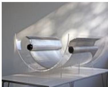
Fig. 6 Schimbător de căldură pentru debit mare de apă uzată [14]
