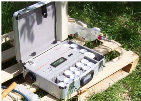
Fig. 2 Detectorul de radon și toron LUK3C, pentru măsurători de radon în sol
