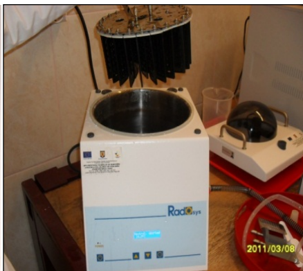
Instalația pentru dezvoltare din cadrul sistemului RadoSys
