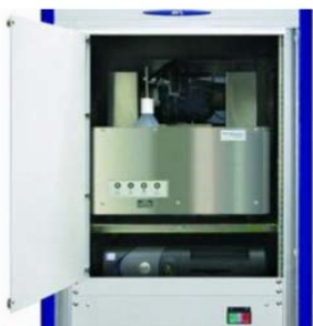
Fig. 1 Cabinetul analizorului de gaze
