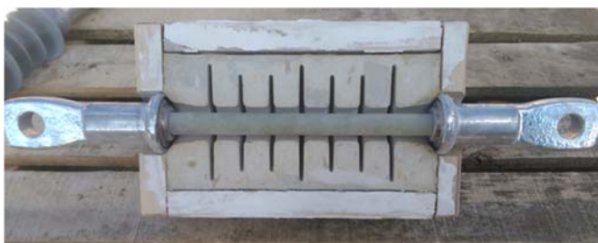
Fig. 3 Matrița și tija izolatorului electric pregătite de turnare
