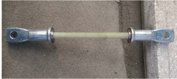
Fig. 1 Tija centrală a izolatorului
