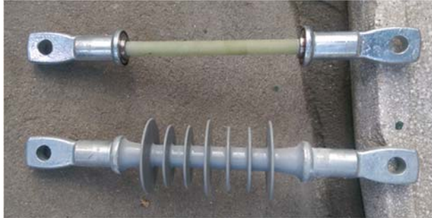
Fig. 5 Tija izolatorului și forma finală a izolatorului C II 20kV 70 kN
