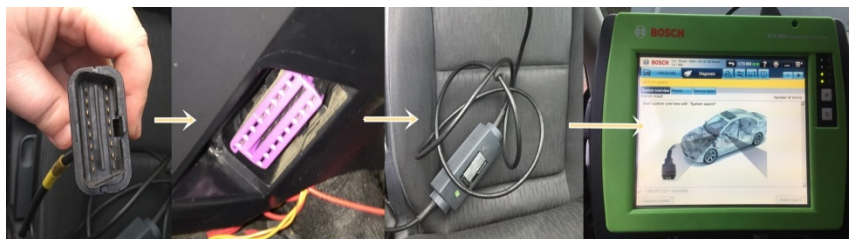
Fig. 3 Modul de conectare fizică între autovehiculul și sistemul de diagnosticare
